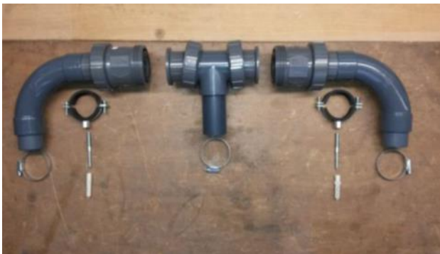
Ett sätt att åstadkomma jämn fördelning mellan två system är att ansluta systemen med rördelar som bilden visar.
